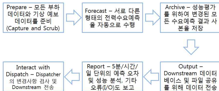
<그림 2-3-2> PJM 시간단위 전력수요예측의 자동화 기능 및 절차
